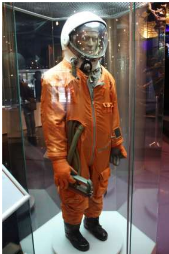
Скафандр "СК-1" мягкой конструкции с вентиляционной системой открытого типа. Предназначался для космонавтов кораблей "Восток". Применялся при всех полетах космонавтов на кораблях "Восток" до 1963 г. Масса 20 кг. Разработан на заводе "Звезда" в 1960-61 гг.
