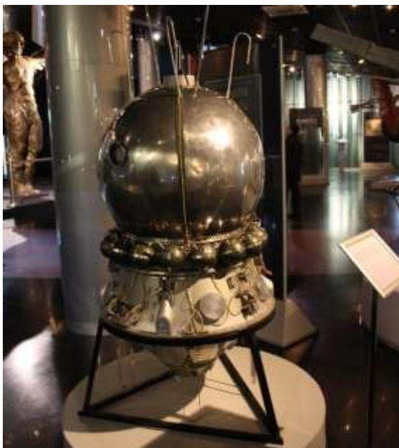
Одноместный космический корабль "Восток" для полетов на околоземной орбите. На первом корабле "Восток", пилотируемом Юрием Алексеевичем Гагариным, 12 апреля 1961 г. был совершен первый полет человека в космос. Макет.М 1:3.
